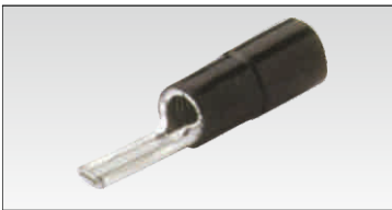
Наконечник силовой “плоская игла” с изоляцией Материал- луженая медь Изоляция - нейлон
